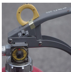
× 表示装置の脱落
